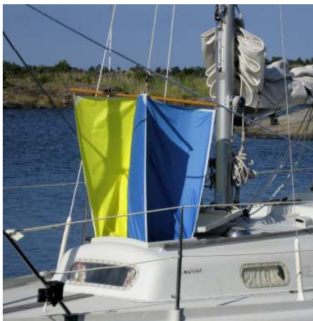
Vindfångaren monterad i förluckan
