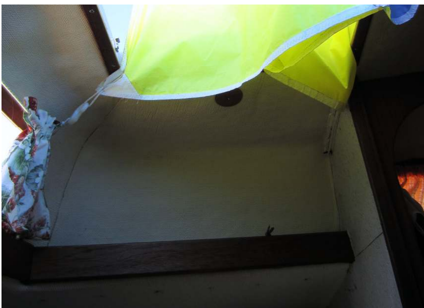
Vindfångaren hakas fast i gardstångsfästet och krok i förliga skottet
