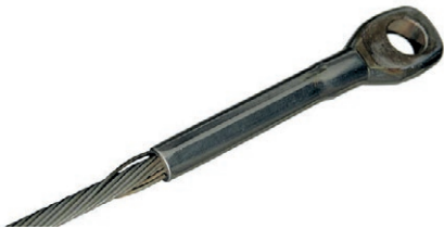
Pressat ändstycke där minst en kardel brustit inne i ändstycket.
